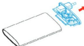
2. Potisnite HDD disk proti SATA konektorju in se prepričajte da ste disk dobro pritrdirili ->
