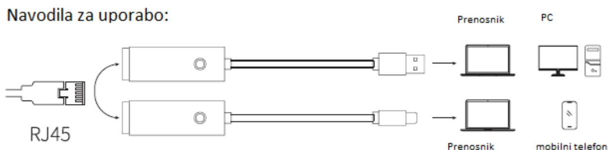
Konec USB adapterja priključite na računalnik, drugi konec pa na vrata LAN RJ45 (plug and play za Windows 8/10/11, drugi sistemi bodo morda morali namestitev gonilnikov).
