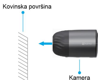
Slika3: Montaža neposredno na kovinsko površino
